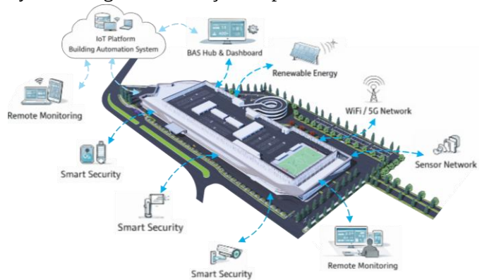
Gambar 8. Konsep Integrasi Sistem IoT dan BAS
