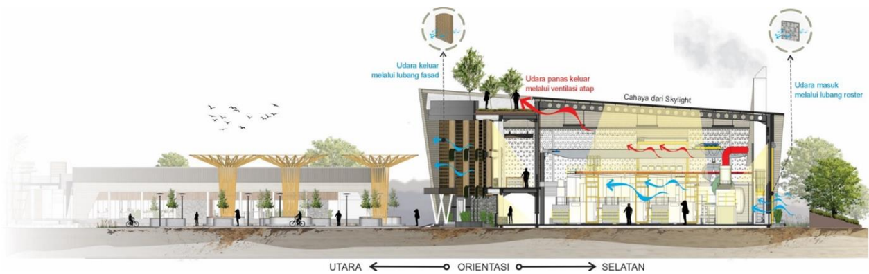
Gambar 4. Skema Penghawaan dan Pencahayaan Alami Pada Bangunan
