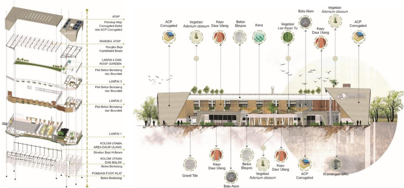
Gambar 6. Struktur Bangunan Utama dan Material Elemen Fasad
